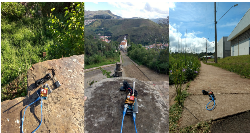
Figura 30 – Inclinômetros dos pontos: Getúlio Vargas, S.F. Paula e Lab. Química respectivamente.
