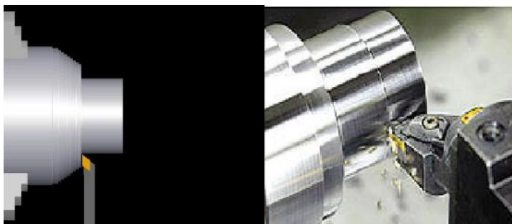
Figura 8 : A esquerda o modelamento computacional de usinagem com MACH 3 versão 1.84, simulando a usinagem real a direita, antes que ela seja executada. Fonte: Projeto Teoria do Corte/Sandvik, 2012.
